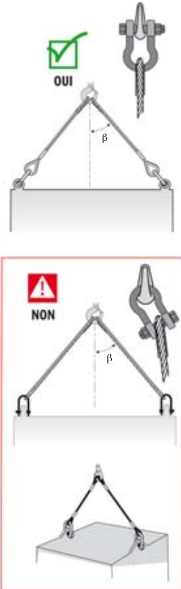
Figure 19 - Montage des manilles
