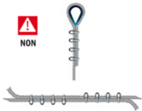
Figure 8 - Assemblages avec serre-câbles
