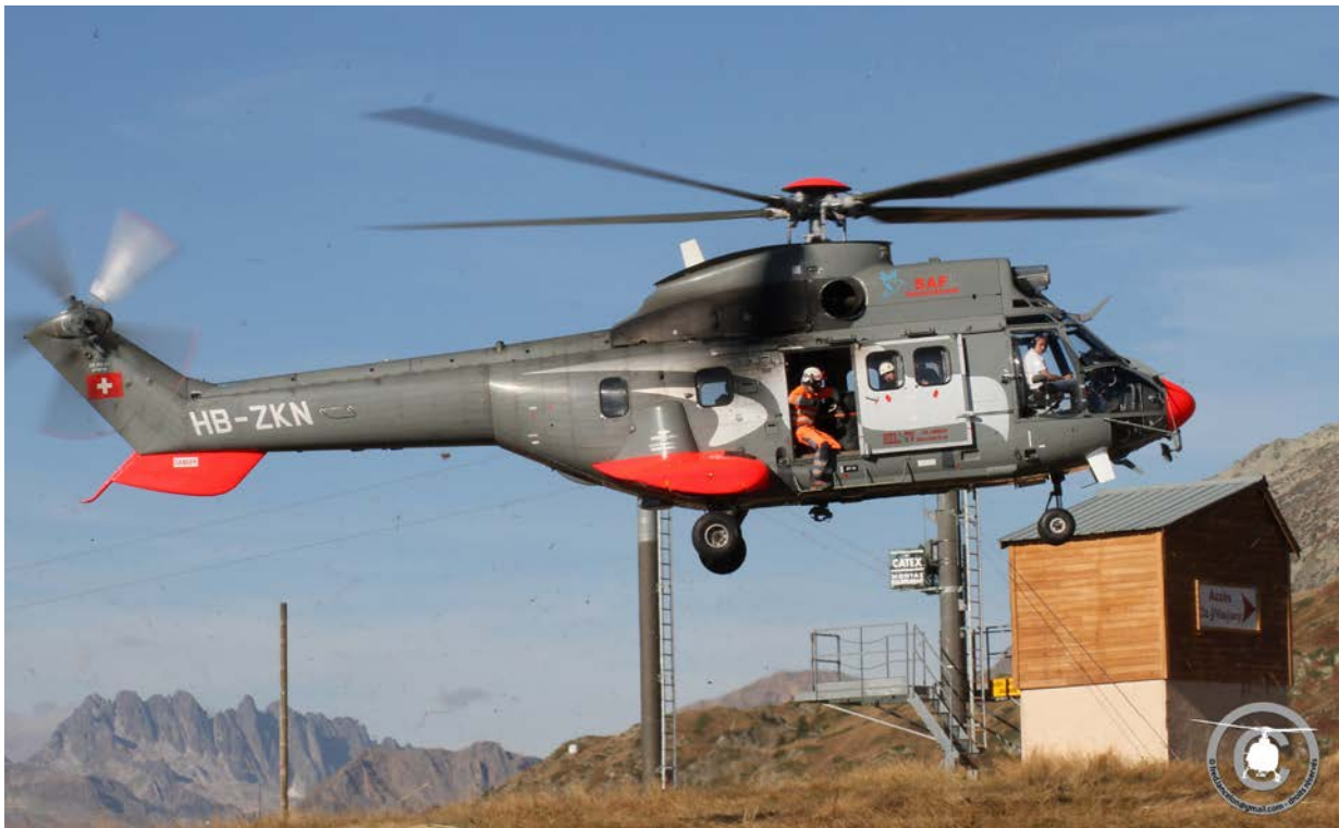
Le SUPER PUMA en action: le helper assujetti à la machine en liaison avec le pilote surveille d'éventuels obstacles au niveau du rotor de queue.
